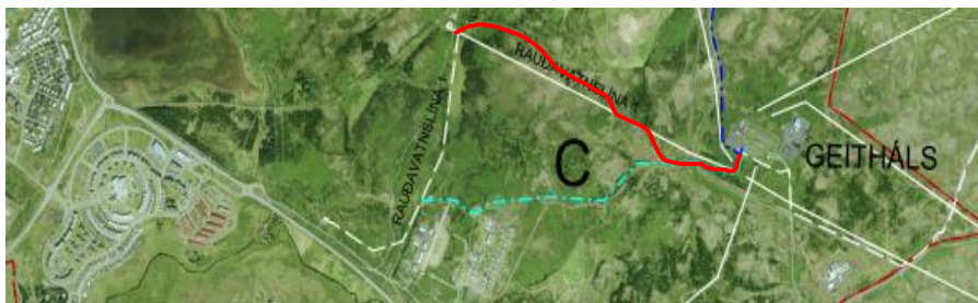
Mynd 8 – Strengleið Rauðavatnslínu 1. Ljósblá leið er tillaga Landsnets, rauð leið er tillaga Reykjavíkurborgar.
