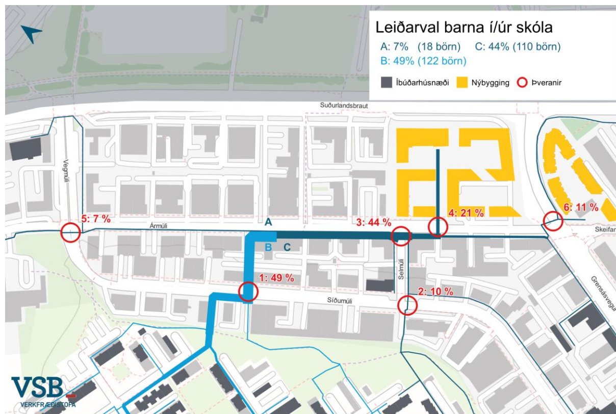
Mynd 9: Mikilvægar þveranir yfir umferðargötur í leið barna í skólann ásamt hlutfalli skólabarna sem þvera þær.
